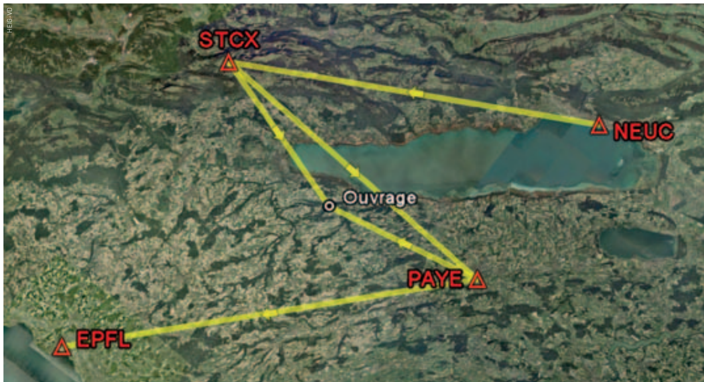
Canevas du réseau GNSS avec les lignes de base.
